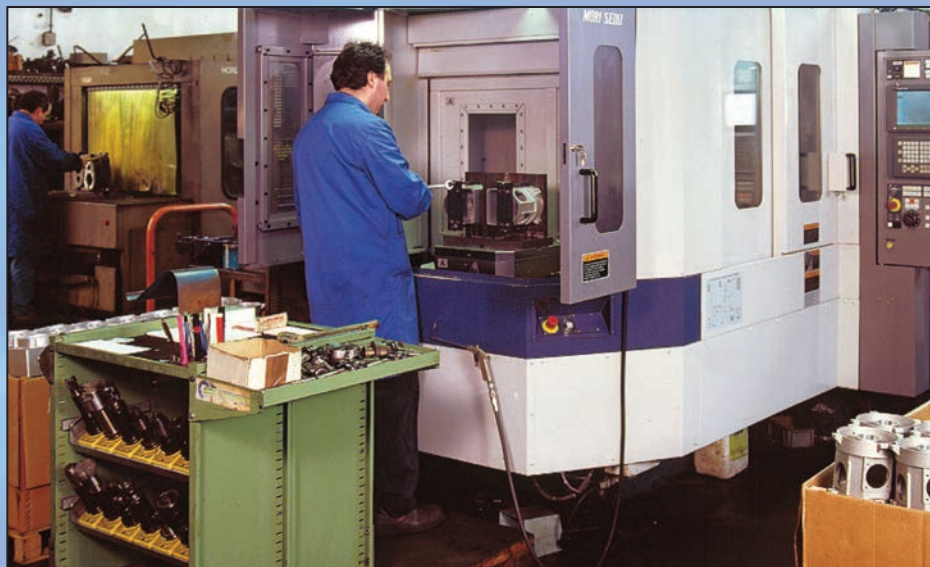
Il nuovo centro di lavoro a controllo numerico durante la lavorazione dei compressori. The new work center at numerical control during the processing of the compressors.
