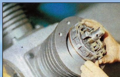
Montaggio della valvola concentrica completa di premivalvola Assembly of the concentric valve complete with valve presser.
